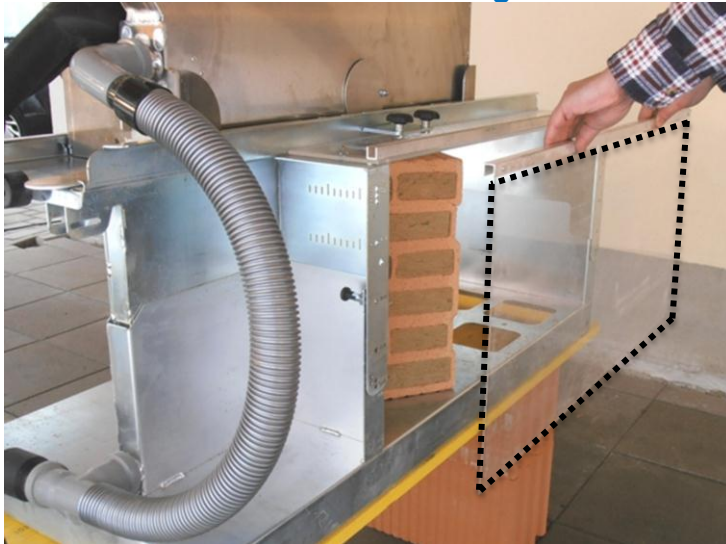
Foto 15 Staubschutz durch Plexiglas - Platten
